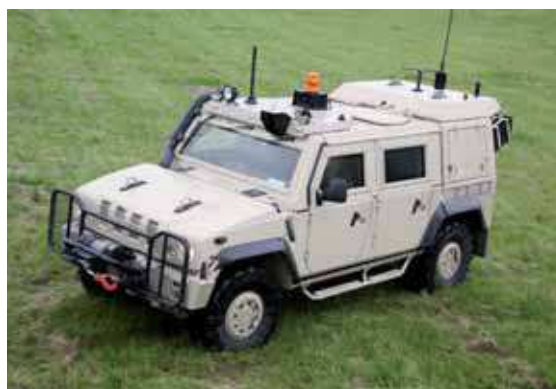
Lehké kolové obrněné vozidlo LMV se systémem STAR V
