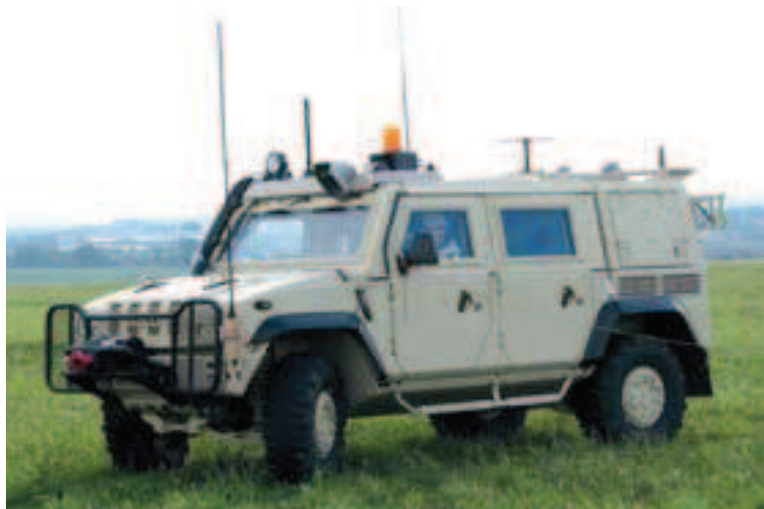
Czeski Iveco LMV podczas prowadzonych jesienią 2009 badań ciężkiego urządzenia zagłuszającego STAR V-700. Wkrótce tak wyposażone pojazdy trafią do czeskiego kontyngentu w prowincji Lohar. Część wozów ma otrzymać także lżejszy wariant STAR Light/6. Z kolei Pandury II obecnie szykowane do swojej pierwszej misji bojowej zostaną wyposażone w tworzone właśnie urządzenia STAR Light/3 / Zdjęcie: URC Systems
