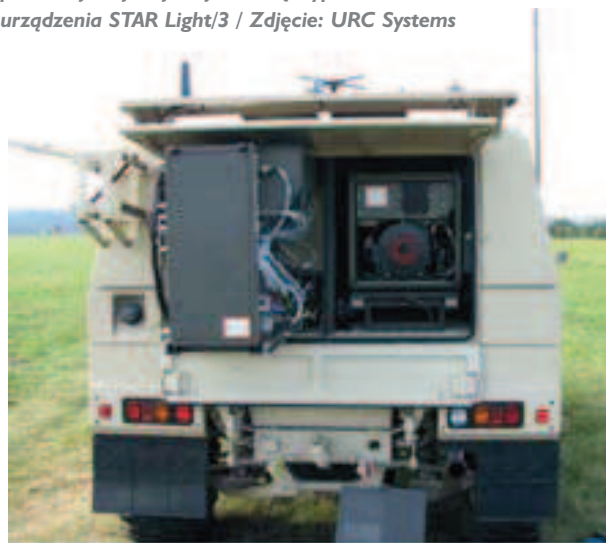
Moduły STAR V-700 i urządzenie zasilające (po prawej stronie), umieszczone w tylnej części LMV
