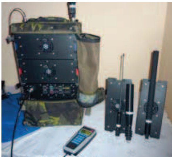
Zestaw STAR Manpack podczas prezentacji w Ambasadzie Republiki Czeskiej z dwoma dodatkowymi, wymiennymi modułami (dla innych zakresów pracy), wymiennymi antenami oraz panelem wprowadzania danych i sterowania, za którego użycie odpowiada dowódca i oficer walki elektronicznej – żołnierz-nosiciel tylko włącza i wyłącza urządzenie
