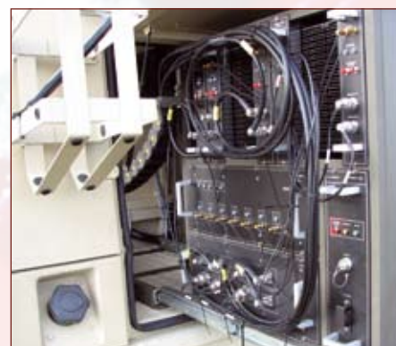
↕ Bloki systemu zakłócającego STAR V700 zabudowane we wnętrzu bagażnika pojazdu opancerzonego Iveco LMV Armii Republiki Czeskiej.
