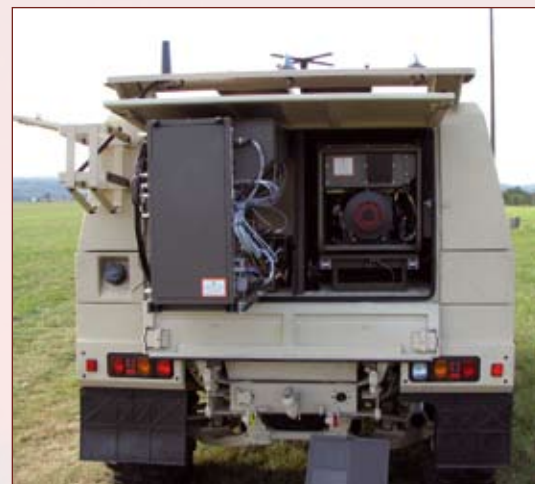
↕ Bloki systemu zakłócającego STAR V700 zabudowane we wnętrzu bagażnika pojazdu opancerzonego Iveco LMV Armii Republiki Czeskiej.
